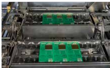
Schmiermittelfreier Rollentransport im Vakuummodul
