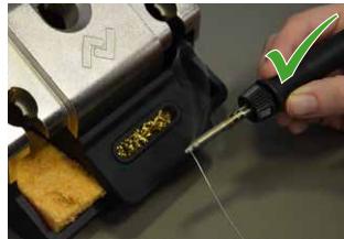
Nach Reinigung neues Lot zuführen
