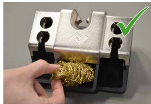
Verschmutzte Metallwolle entfernen, Lotauffangbehälter leeren
