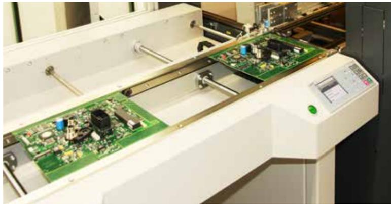
Vollautomatisch breitenverstellbarer Zuführtransport.
