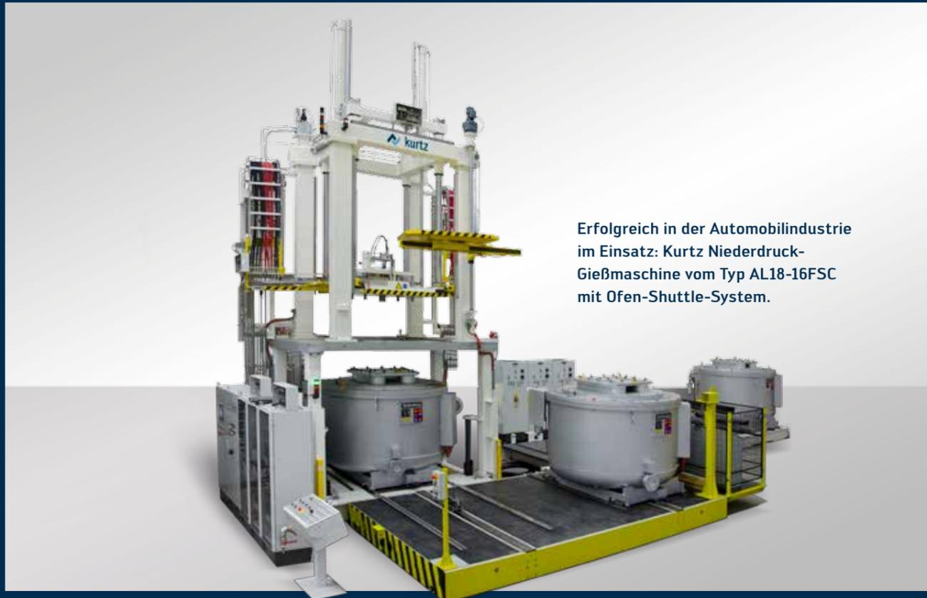
Erfolgreich in der Automobilindustrie im Einsatz: Kurtz Niederdruck-Gießmaschine vom Typ AL18-16FSC mit Ofen-Shuttle-System.
